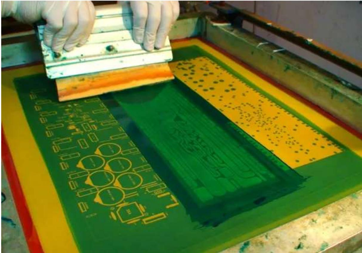
„Manuelle Anbringung einer Siebdruckätzmaske bei der Herstellung einer PCB“,
